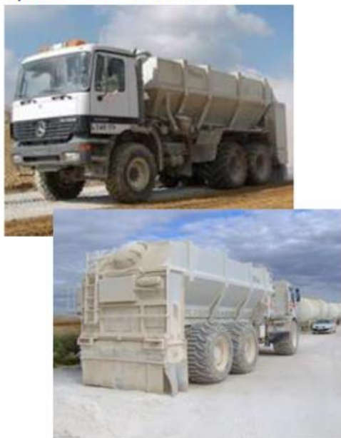
Figure 6 - Engins de chantier utilisés pour le traitement des remblais
