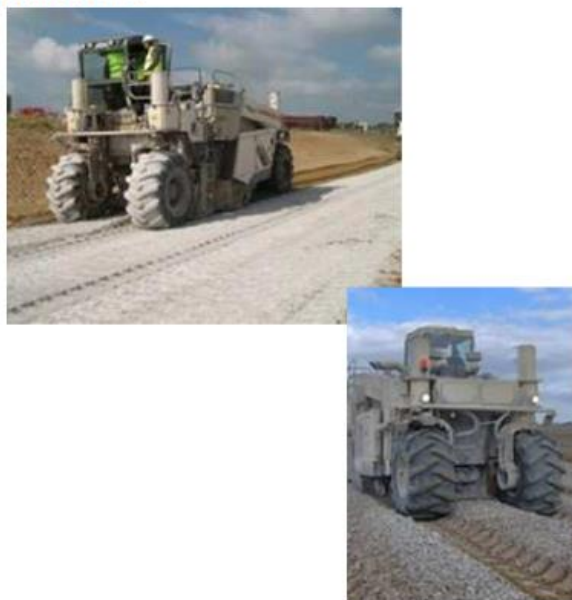
Figure 6 - Engins de chantier utilisés pour le traitement des remblais
